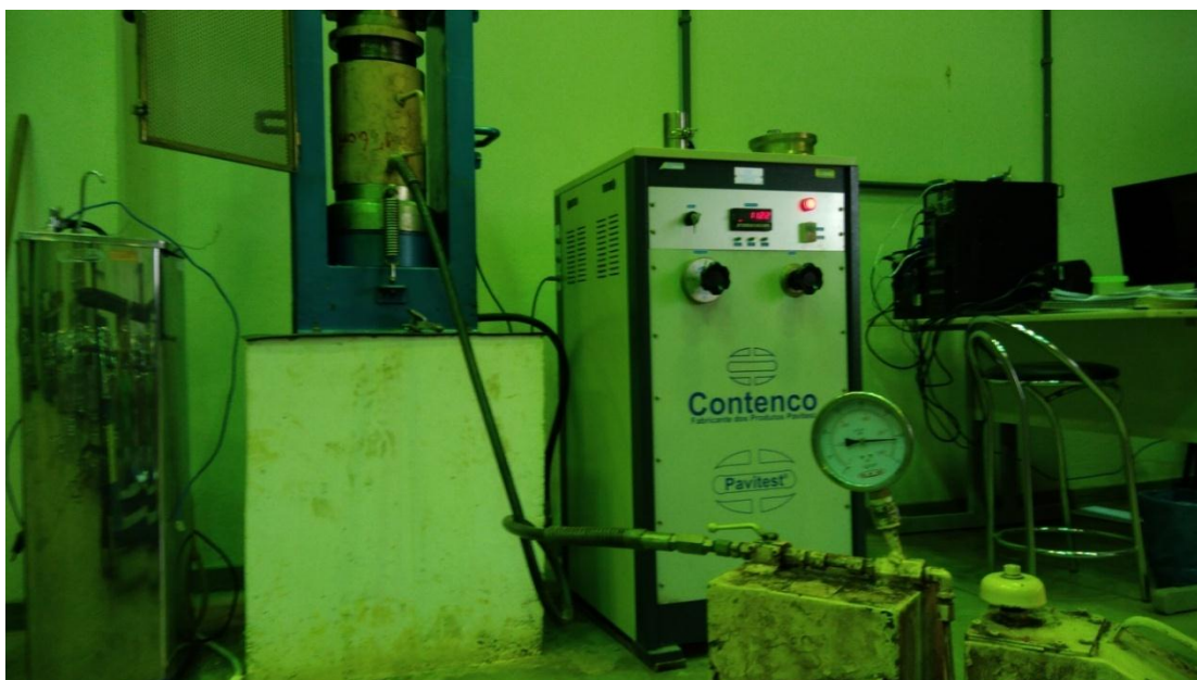
Figura 25 - Calibração do manômetro com a utilização da prensa
