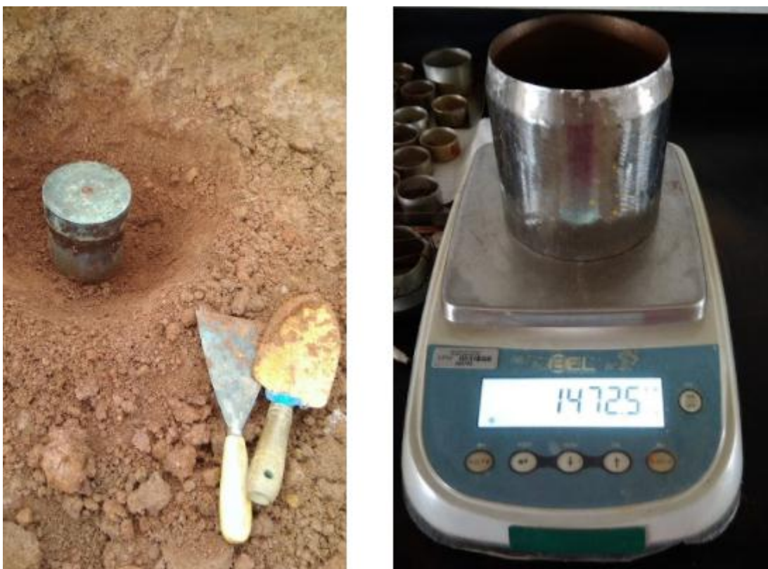
Figura 30 - Extração do cilindro biselado com o corpo de prova e pesagem do cilindro
