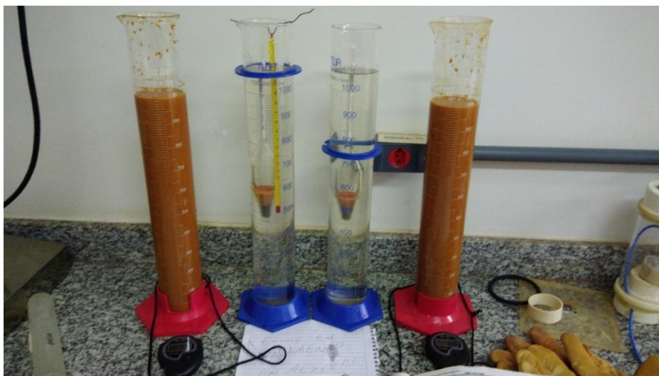
Figura 13 - Ensaio de sedimentação em execução
